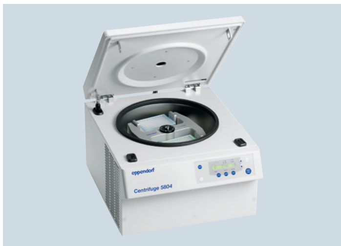
Centrifuge 5804 con rotor de placas A-2-DWP
